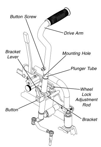
FIGURE 2 - ADJUSTING DRIVE ARM HEIGHT
